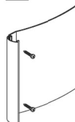
**1** Das Clipprofil aufklappen und die Abdeckung entnehmen. Nach dem Setzen der Dübel das Schild mit zwei Schrauben in der gewünschten Position und Ausrichtung anbringen.
