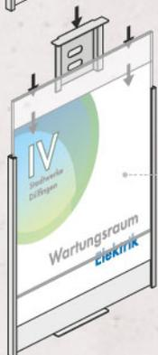
2 Das Papier einlegen und die Abdeckung sowie die Halterung wieder aufsetzen.
